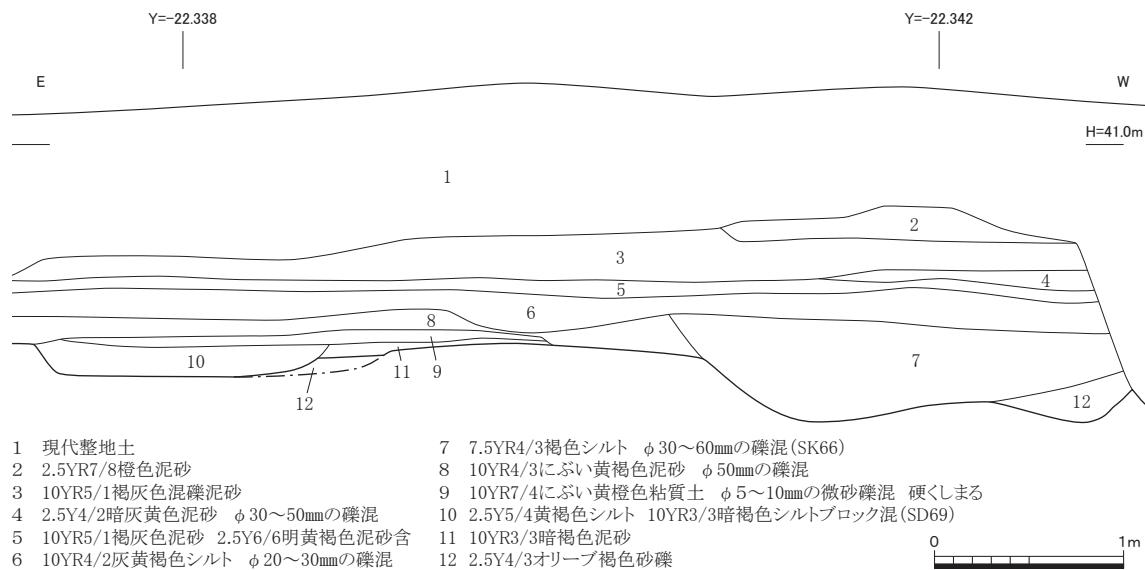
図10 土坑SK66、溝SD69断面図 (1 : 40)
