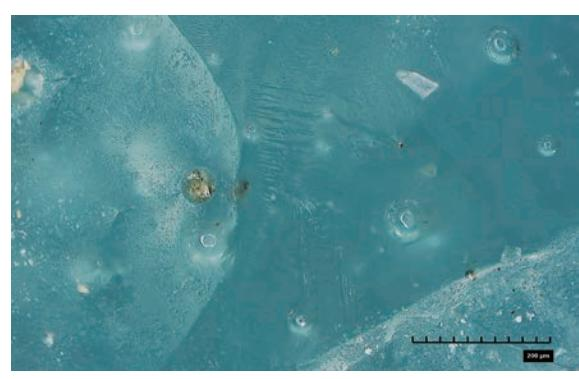
写真 1 - 4 : ガラス破断面の拡大観察
