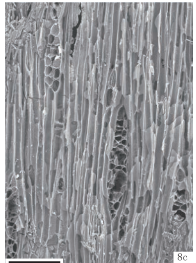
a:木口,b:柁目,c:板目 スケール:0.1mm
