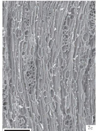
a:木口,b:柁目,c:板目 スケール:0.1mm
