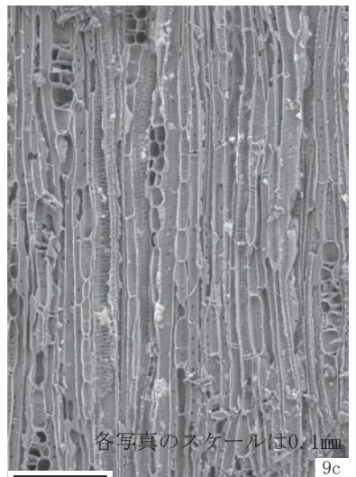
a:木口,b:柁目,c:板目 スケール:0.1mm
